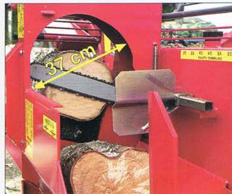
Diamètre maximum de la bille: 37 cm. Force de fendage: 5,5 t. Cylindre de fendage de 7,0 t en option.
