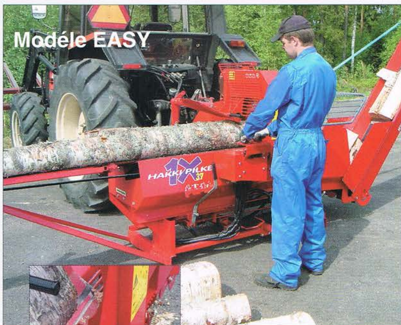
La table d'alimentation amène la bille dans la machine. La machine est commandée par un levier manuel.
