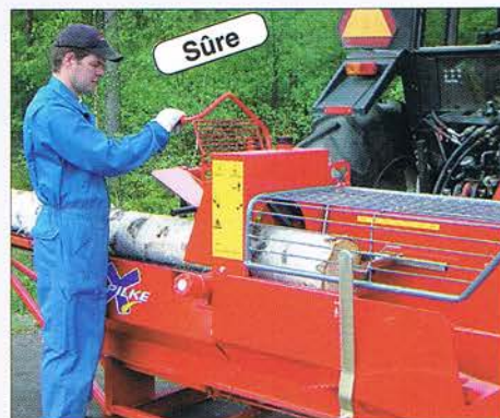
Bonne position de travail ergonomique: coupe avec la main droite. Coupe et fendage dans un espace totalement protégé.
