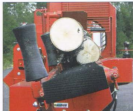
Grâce à la légère inclinaison de la table d'alimentation, le bois tordu reste sur la table.
