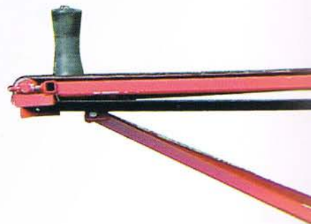
Grâce à la légère inclinaison de la table d'alimentation, le bois tordu reste sur la table.
