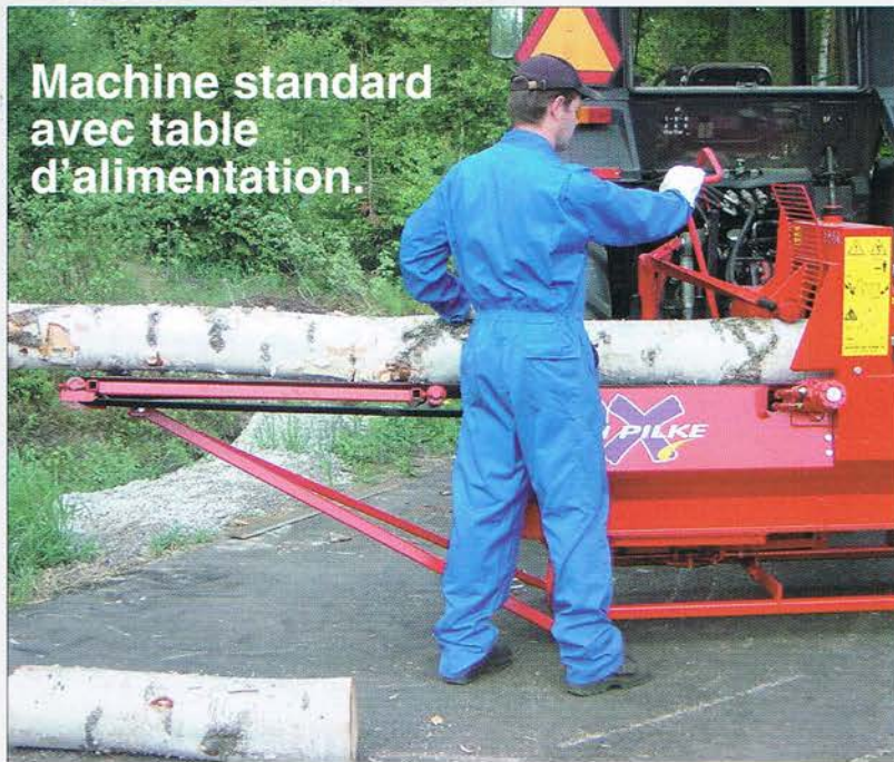
La table d'alimentation amène la bille dans la machine. La machine est commandée par un levier manuel.
